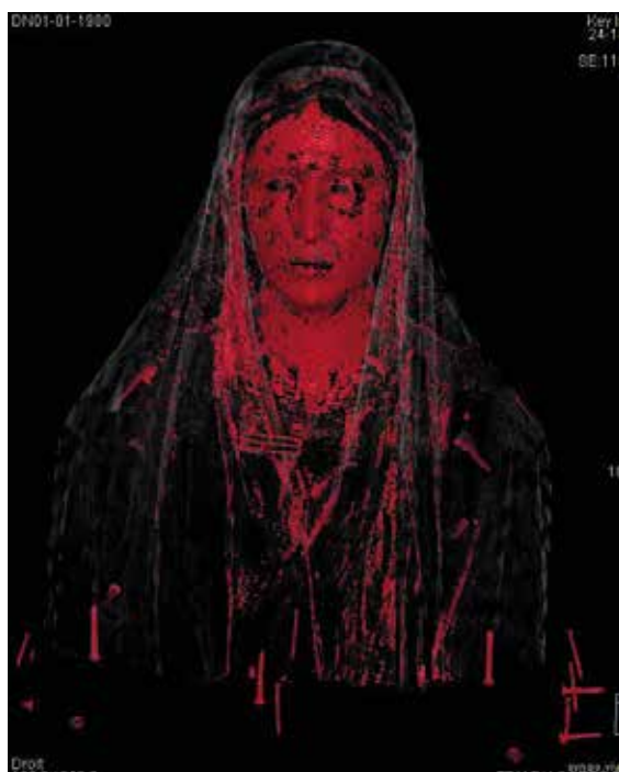
D'3D-Rekonstruktioun weist déi dicht Materialien, wéi Eisen oder Bläiwäiss, als roud Zonen.
